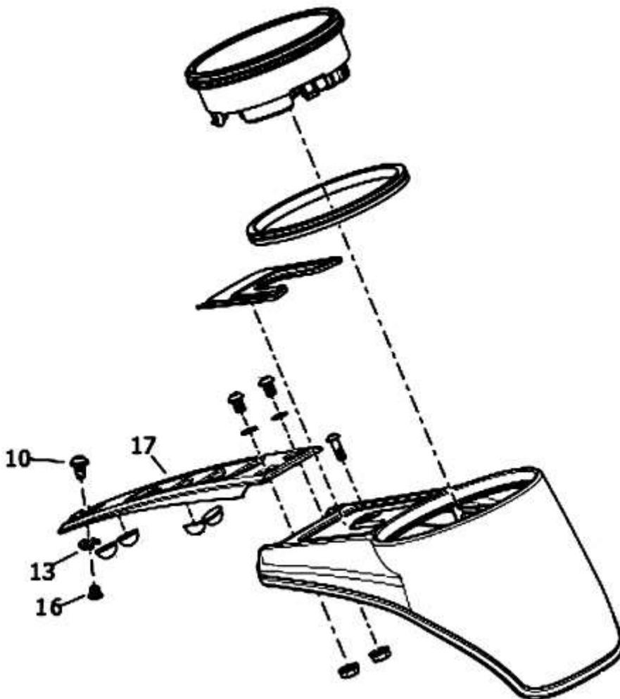
Lösen Sie die hintere Schraube (10) vom Tank-Dash (17).
